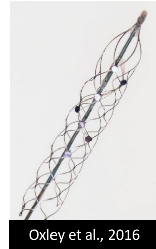
Stentrode; platinum = 50µm
